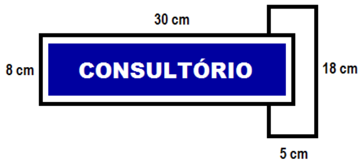
Figura 1 – Medidas de placa de identificação interna (Lateral).
